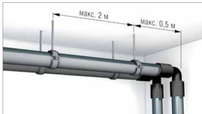
Рис. 7-3 Максимальное расстояние между хомутами
