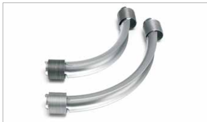
Рис. 9-5 Фиксаторы поворота (водоснабжение) (4 x Ø) – 90° и фиксаторы поворота (водоснабжение / отопление) (5 x Ø) – 90° для изгиба труб Ø 32
